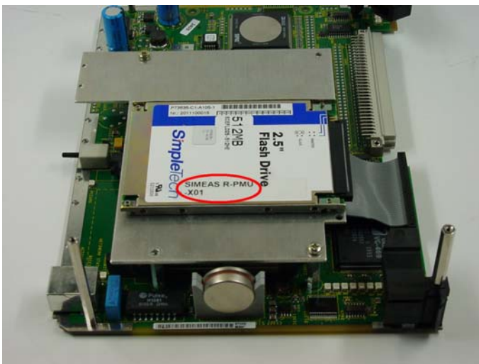
Abbildung 23: Flashdisk auf der CPU-Baugruppe
